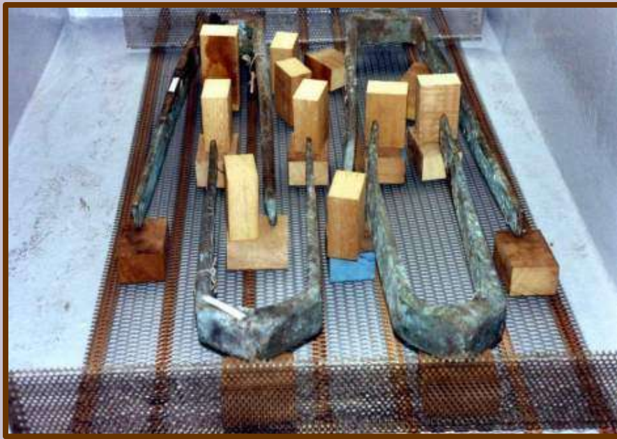
Fémelots de gouvernail avant et après traitement
