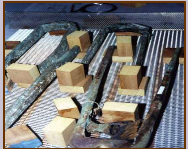
Fémelots de gouvernail avant et après traitement
