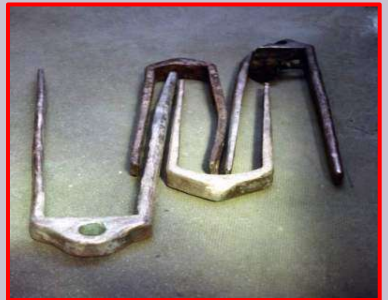
Fémelots de gouvernail avant et après traitement
