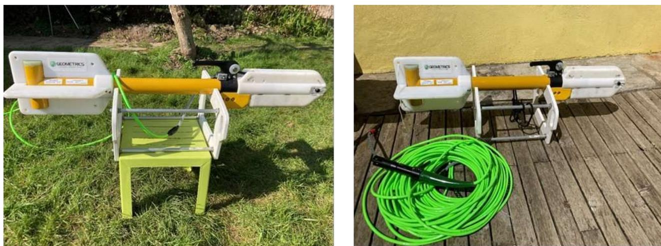
Figure 6 : Magnétomètre « Géométrics » de la SAMM
