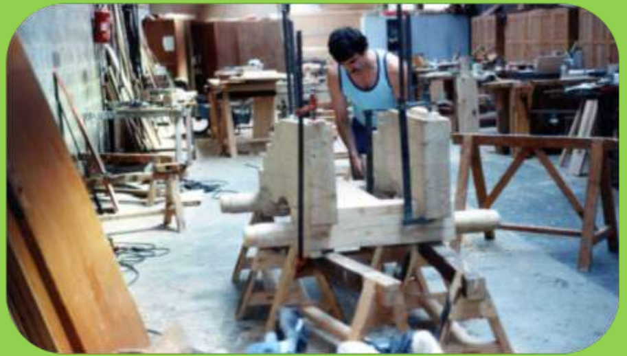
Montage de l'affût - essieux, sole et flasques (orme et chêne)
