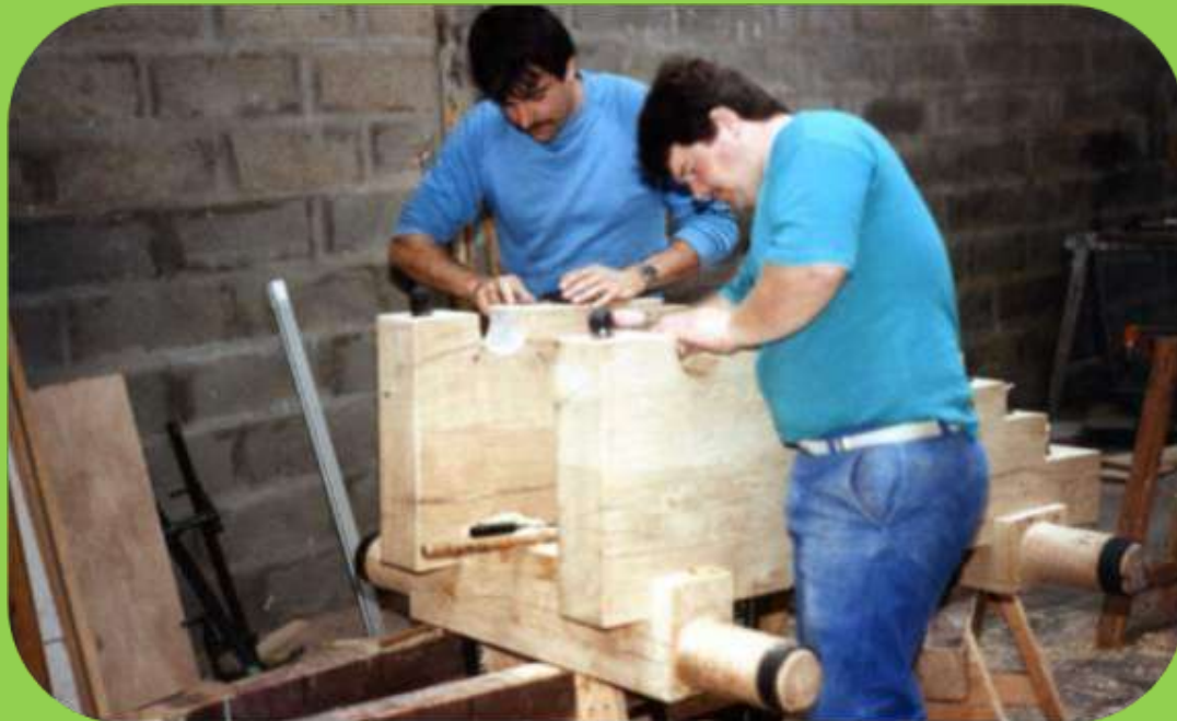
Montage de l'affût - essieux, sole et flasques (orme et chêne)
