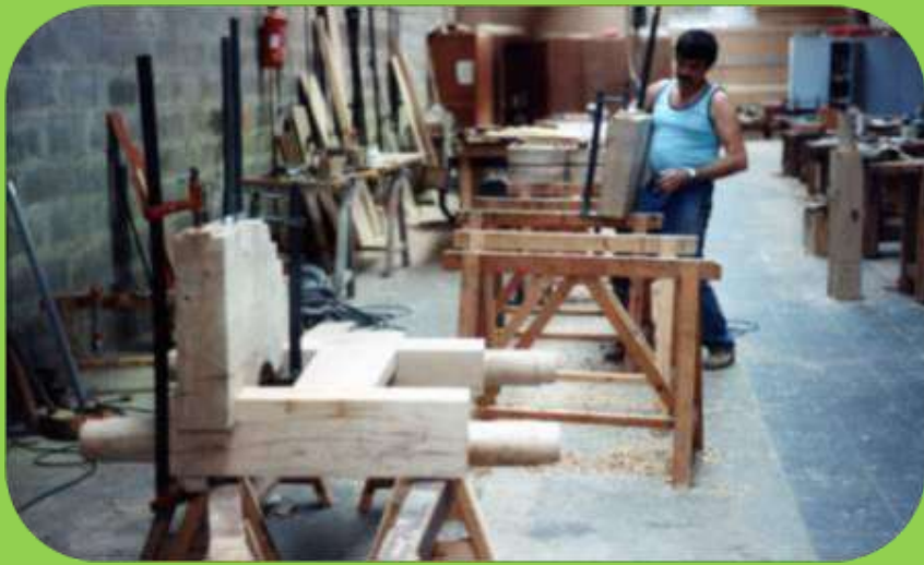
Montage de l'affût - essieux, sole et flasques (orme et chêne)
